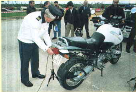
Comprobación del nivel sonoro de una moto de la policía de Amsterdam.
